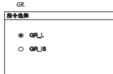
如果國家代碼設定為 DE，液晶上會顯示針對德國的電網類型代碼。按 ▼ 選擇電網代碼，按 **ENTER** 確認選擇。低壓表示低壓電網；中壓表示中壓電網，高壓表示高壓電網。
